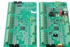
Ведущая и ведомая печатные платы выхода на светодиоды
