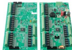
Ведущая и ведомая печатные платы релевого выхода
